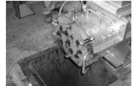
発生した灰を固形化して処理する装置
