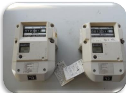
ガスメーター
