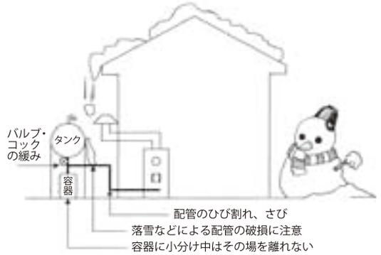
配管のひび割れ、さび 落雪などによる配管の破損に注意 容器に小分け中はその場を離れない
