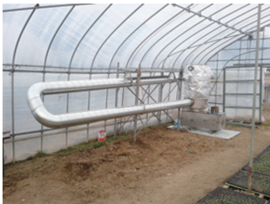
木質バイオマスを利用した ロケット式熱源の開発 (有)太田鉄工所)
