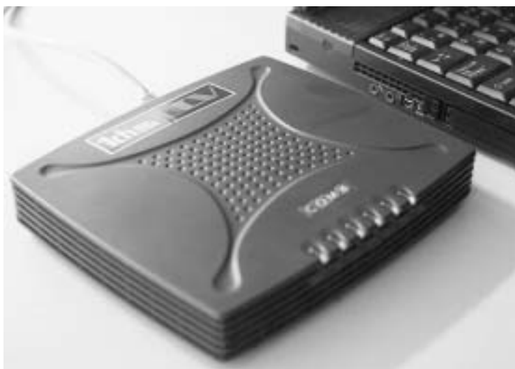
UCVのケーブルモデム 同軸ケーブルを差し込み、パソコンとつなぐ。
