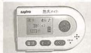
▲「高精度携帯型運動量連続測定装置」(熱大メイト)
