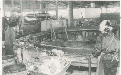
不燃物の中に混ざる空き缶、空きびんなどの資源物を分別します。ターンテーブル方式で一日約20トン进行处理。乾電池は保管、こん包して北海道の処理業者へ
