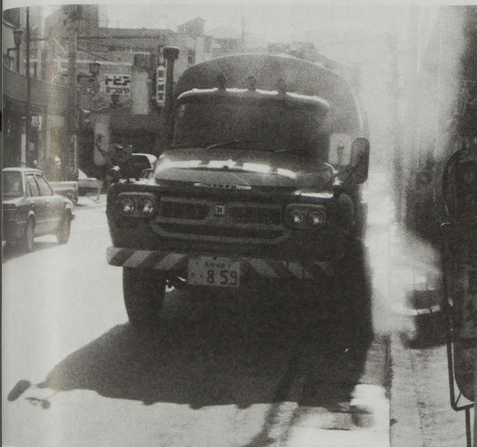
道路端にたまった粉じんを清掃する大型清掃車
