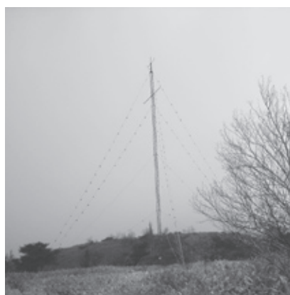
根子岳風力発電の風況調査塔(高さ50m)
