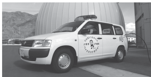
天然ガス車(下水汚泥から発生したメタンガスが燃料)
