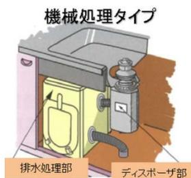
図 5-12 機械処理タイプのディスポーザーの例
