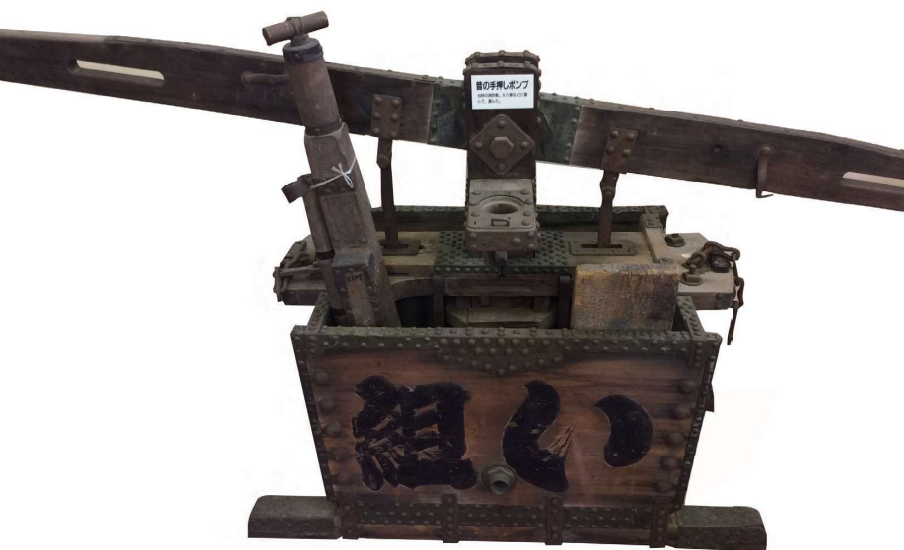
染屋浄水場の水道資料館に展示されている江戸時代の消火用手押しポンプ。防火用水としても水は必要とされた。
