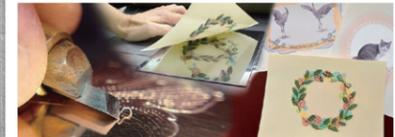
「ビュラン彫り」…鋼鉄製の特殊な彫刻刀による細密な彫刻技術。お札の原版作製でも用いられる。
