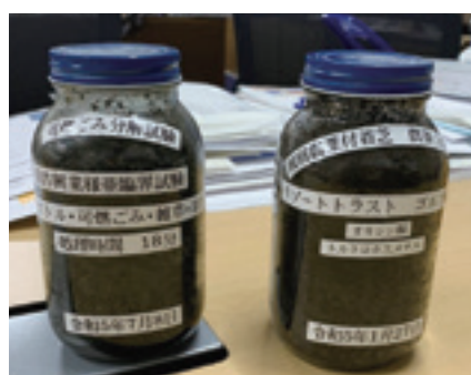
◀可燃ごみや残留農薬が付着した芝を亜臨界水処理して作った肥料
