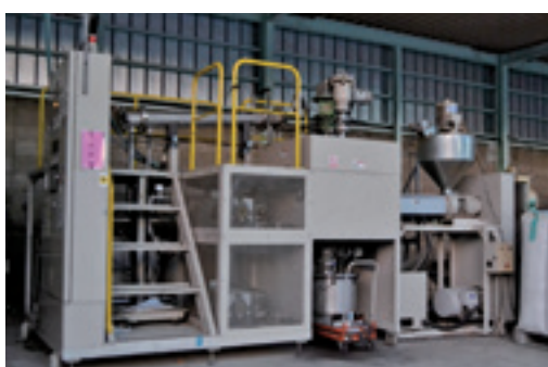
◀廃プラスチック油化還元装置
