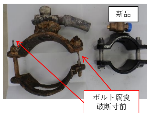
ボルトの腐食
