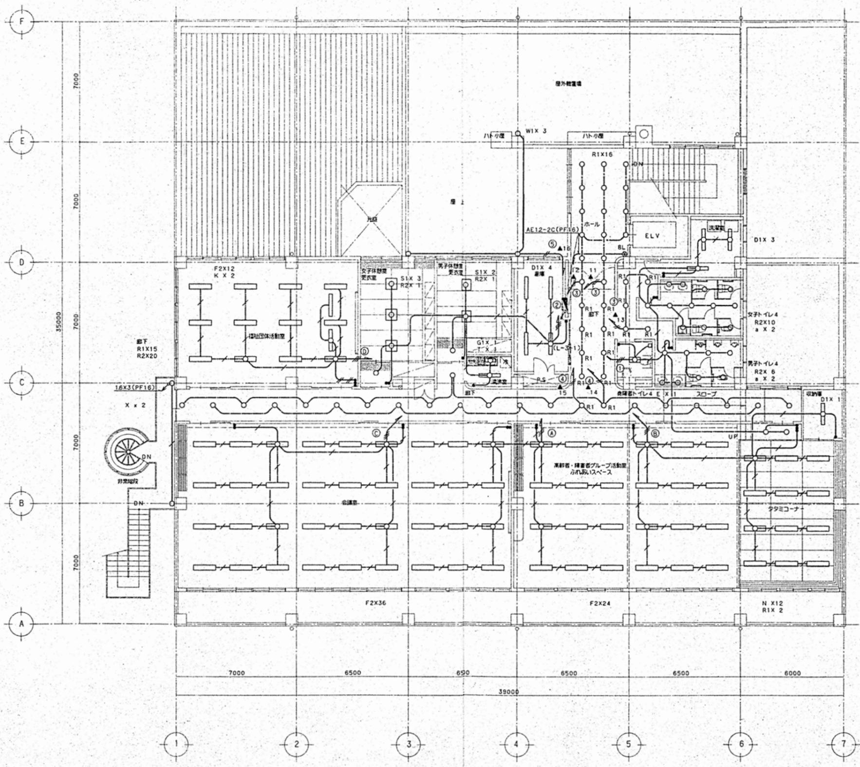
図中の照明器具は全て撤去、処分とする
